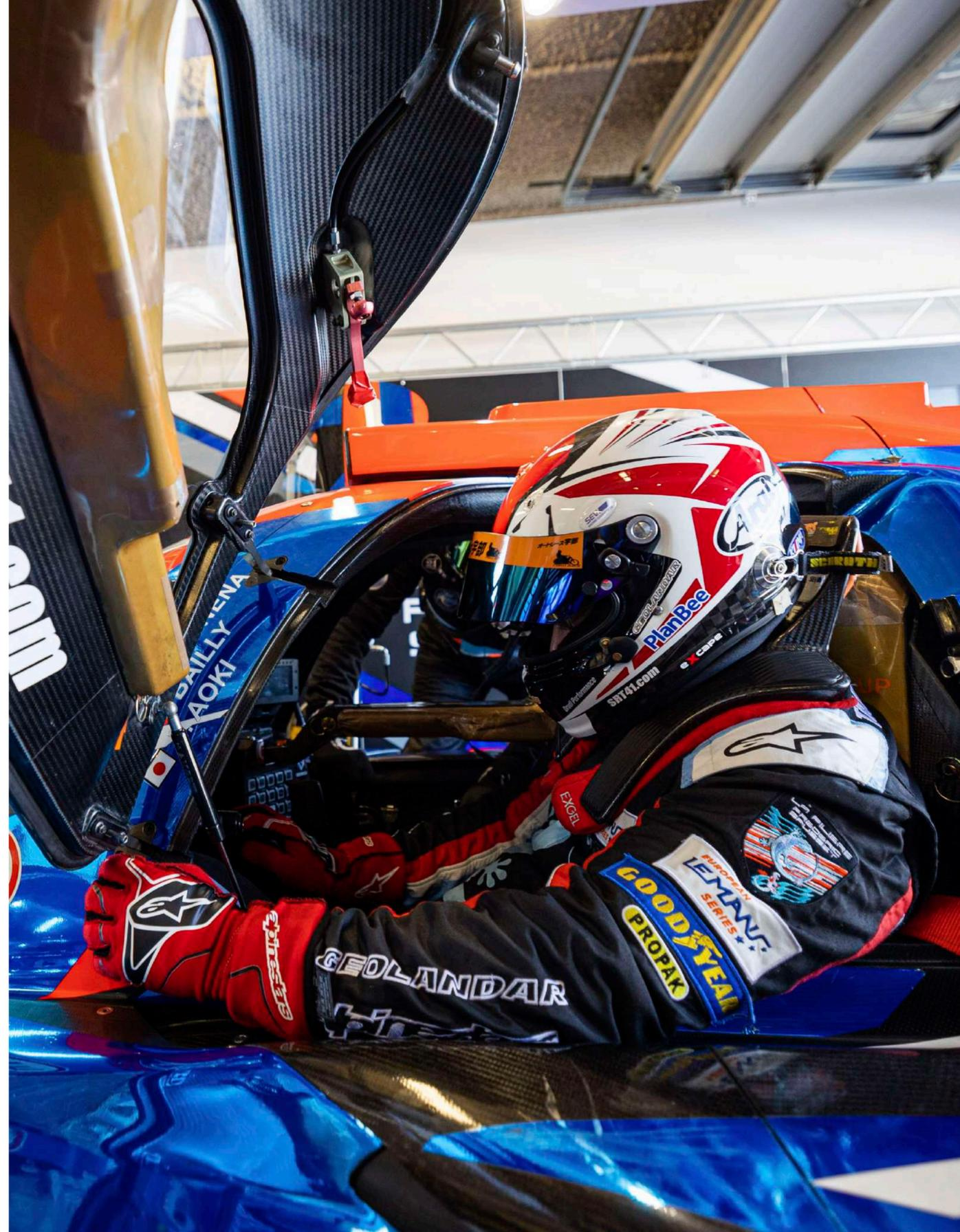
Le pilote peut avoir le contrôle de l'accélérateur et des freins soit au volant, soit aux pédales. Le type de commande, pédale ou volant, se fait par un interrupteur sur la switch panel. Cette sélection ne peut-être faite que moteur arrêté et la voiture ne pourra redémarrer qu'après un check que le pilote est capable de mettre de la pression de frein.
